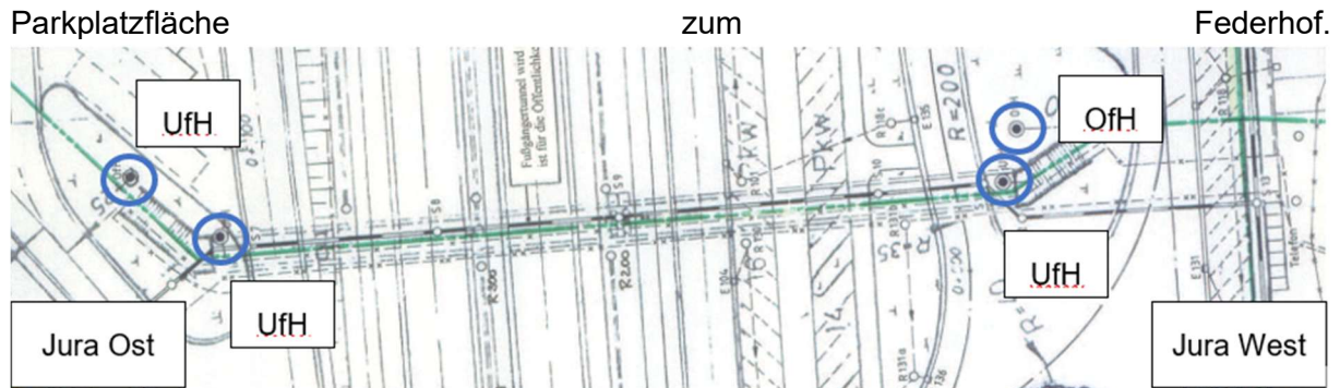
Abb. 11 Wasserleitung mit Anschlüssen
